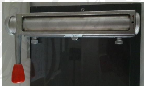
รูปที่ 3.3 Hopper สำหรับเตรียมแผ่น PLC
