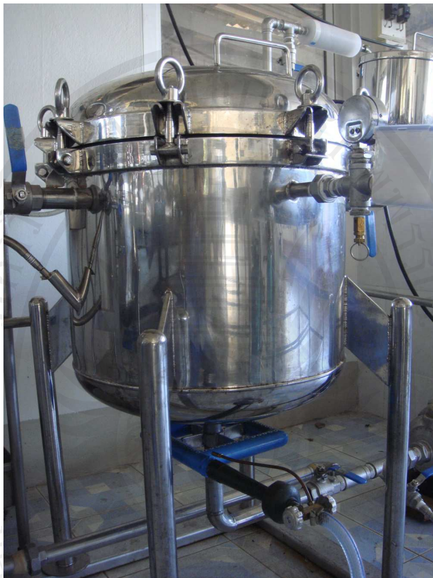
ภาพภาคผนวก 2 Acetic acid fermentation tank
