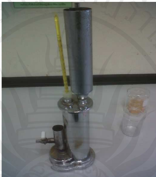
ภาพที่ 5 การหาปริมาณร้อยละของแอลกอฮอล์โดยวิธี Ebulliometric analysis ด้วย อีบูลลิอิมิเตอร์ (Ebulliometer) รุ่น N : 00192
