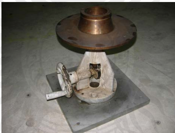
รูปที่ 3.6 ชุดทดสอบการไหลของมอร์ตาร์ (Flow Table)
