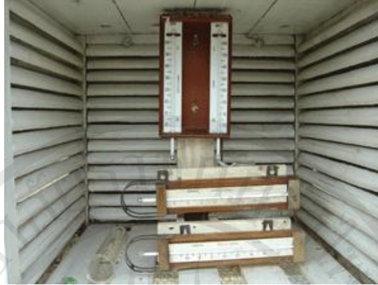
ภาพที่ 2.1 แสดงเทอร์โมมิเตอร์ต่ำสุด - สูงสุด
