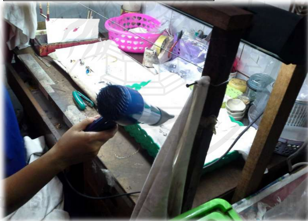
ขั้นตอนที่ 6 การเป่าให้แห้งหลังจากชุปน้ำยาเคลือบ
