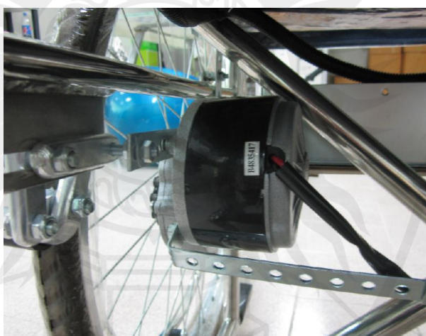
ภาพที่ 4.7 ตำแหน่งการติดตั้งดีซีมอเตอร์
