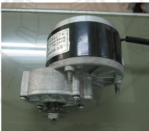
ภาพที่ 4.5 แสดงดีซีมอเตอร์ในระบบส่งกำลัง
