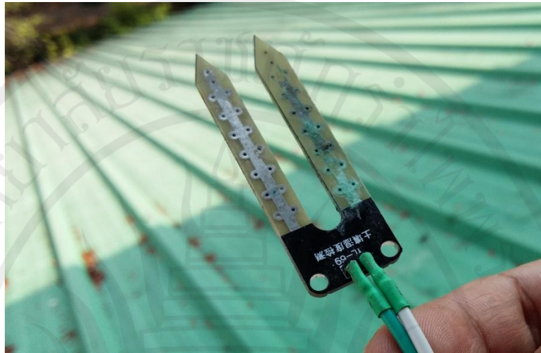
ภาพที่ 4.5 เซนเซอร์วัดความชื้นสัมพัทธ์ของดินที่เสื่อมสภาพ หลังจากใช้งานประมาณ 30 วัน
