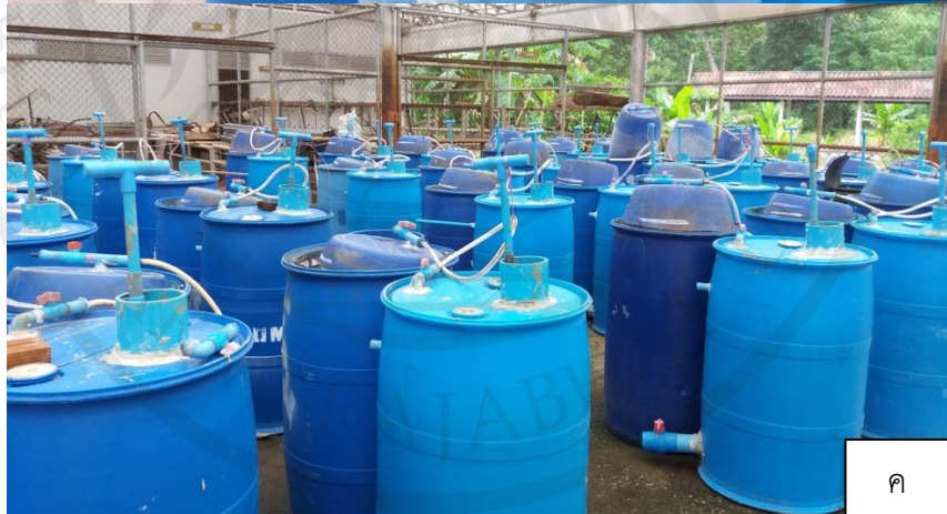
ภาพภาคผนวกที่ 4 การวางเรียงถัง ก) จัดเรียงถังตามแผนผังการทดลอง ข) เติมน้ำในถังเปล่า ค) ต่อสายนำก๊าซเข้าสู่ชุดถังหมักกับถังลอย
