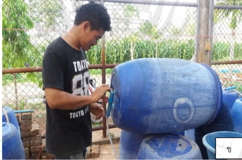
ภาพภาคผนวกที่ 2 การเตรียมถัง ก) ตากถังให้แห้ง ข) ต่อหัวท่อสำหรับเก็บก๊าซปล่อยก๊าซ
