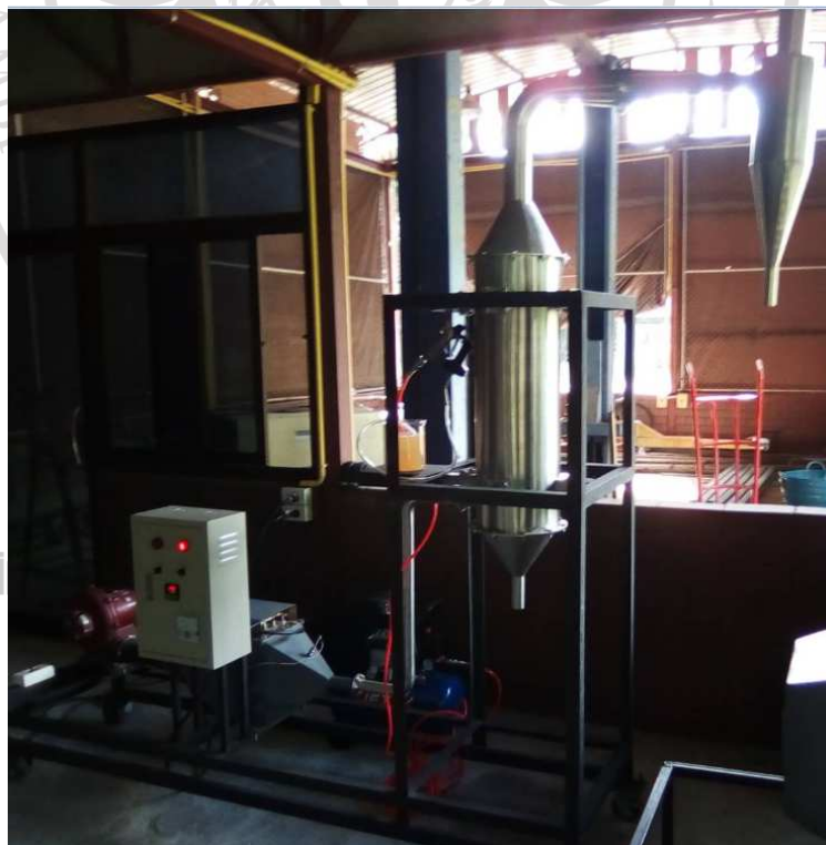
ภาพภาคผนวกที่ ก.10 การทดลองการทำงานเครื่องอบแห้งพ่นฝอย
