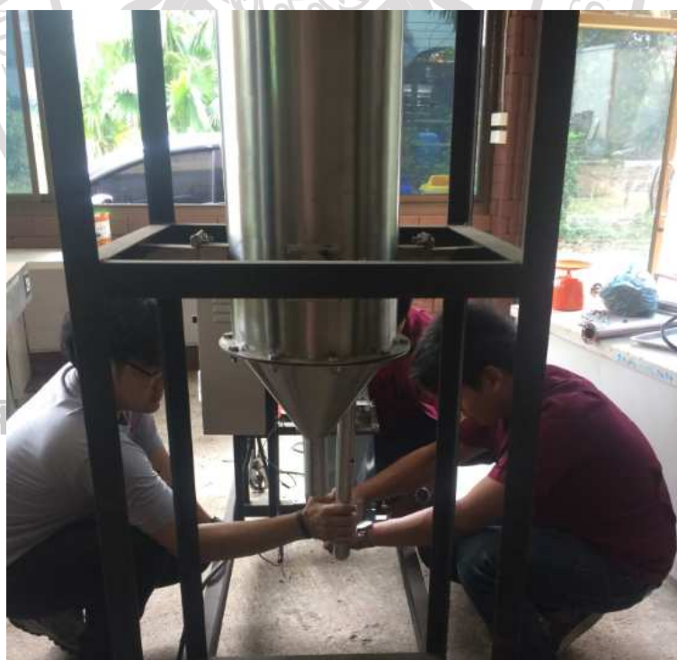
ภาพภาคผนวกที่ ก.8 การประกอบท่อลมร้อนชุดฮีตเตอร์เครื่องอบแห้งพ่นฝอย
