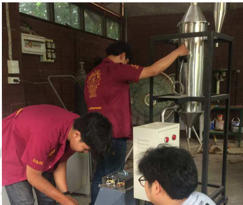
ภาพภาคผนวกที่ ก.7 การต่อประกอบท่อลมร้อนกับชุดฮีตเตอร์เครื่องอบแห้งพ่นฝอย
