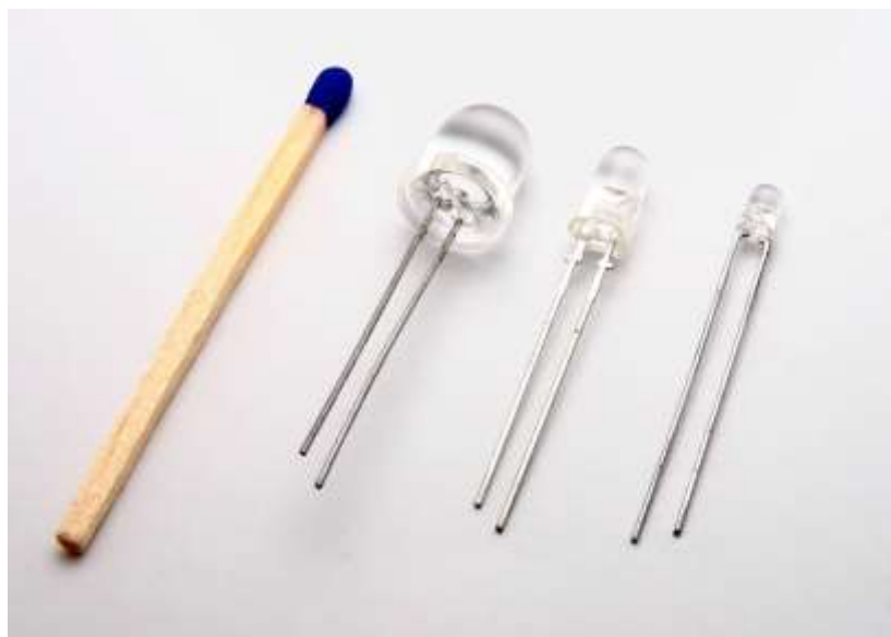
รูปที่ 2.3.2 แอลอีดีขนาด 8 ม.ม. 5 ม.ม. และ 3 ม.ม. เทียบกับไม้ขีดไฟ (ที่มา : เว็บไซต์ http://www.en.wikipedia.org/wiki/LED , 2017)
