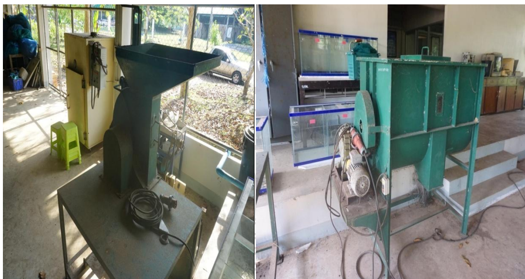
ภาพภาคผนวกที่ 3 เครื่องบดวัตถุดิบอาหารและเครื่องผสมอาหารแบบแนวนอนที่ใช้ในการทดลอง
