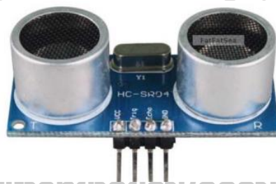
ภาพที่ 2.13 มอดูลตัวรับรู้คลื่นเสียงความถี่สูง (ที่มา : บริษัท อินโนเวทีฟ เอ็กเพอริเมนต์ จำกัด, 2558)
