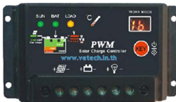
ภาพที่ 2.3 ลักษณะของเครื่องควบคุมการชาร์จประจุแบตเตอรี่
