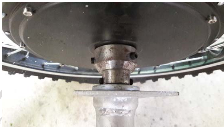
ภาพที่ 4.6 โครงสร้างจักรยานในส่วนจับยึดเพลากลาง
