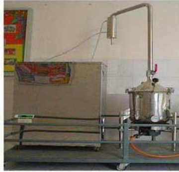
ภาพที่ 2.6 ชุดเครื่องสกัดน้ำมันหอมระเหยขนาดเล็ก (พิเชษฐ์ เทบารุง และสมศักดิ์ ระยัน, 2550)
