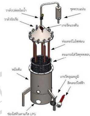
ภาพที่ 2.5 ชุดเครื่องสกัดน้ำมันหอมระเหยขนาดเล็กติดตั้งท่อเทอร์โมไซฟอน (นำพน พิพัฒน์ไพบูลย์ และคณะ, 2557)
