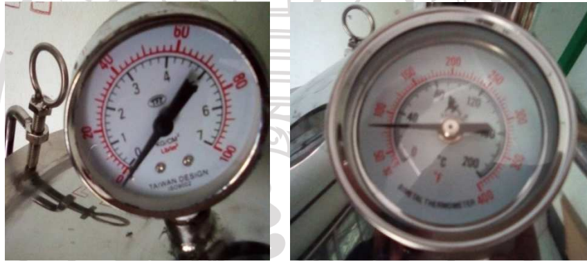
ภาพที่ 3.7 ติดตั้งเกจวัดความดันและวัดอุณหภูมิ
