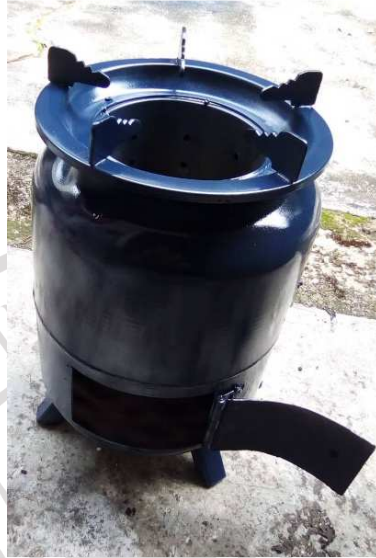
ภาพที่ 4.7 เตาชีวมวลสำหรับให้ความร้อนหม้อต้มกลั่น
