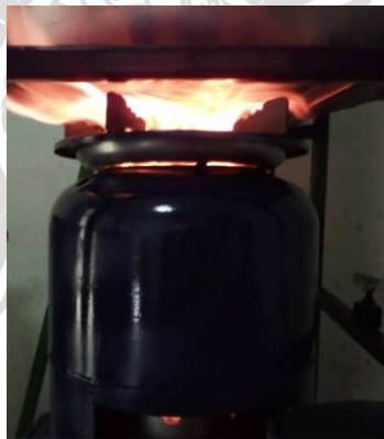
ภาพที่ 4.8 การให้ความร้อนหม้อต้มวัตถุดิบ
