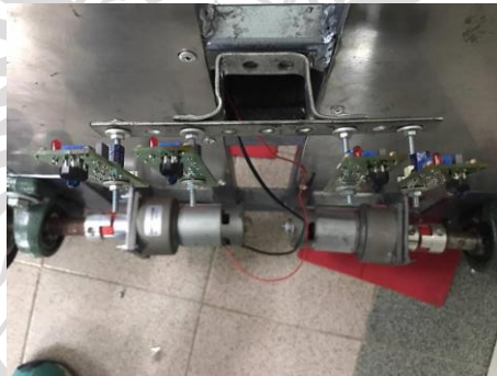
ภาพที่ 3.24 แสดงการต่อเซนเซอร์ตรวจจับแสง
