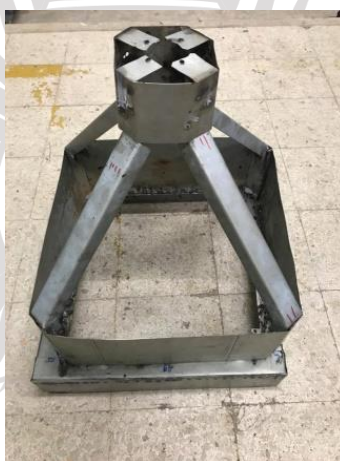
ภาพที่ 3.18 โครงสร้างฝาครอบหุ่นยนต์ประชาสัมพันธ์
