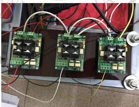
ภาพที่ 3.22 แสดงการต่อสายไปเข้ากับบอร์ดขับเคลื่อนมอเตอร์
