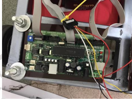
ภาพที่ 3.23 แสดงการต่อสายไฟเข้ากับไมโครคอนโทรลเลอร์
