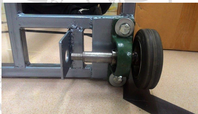
ภาพที่ 3.16 การติดตั้งล้อขวา
