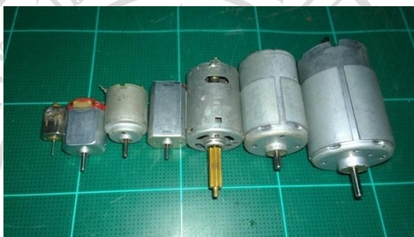
ภาพที่ 2.5 แสดงลักษณะมอเตอร์ดีซีขนาดต่างๆ
