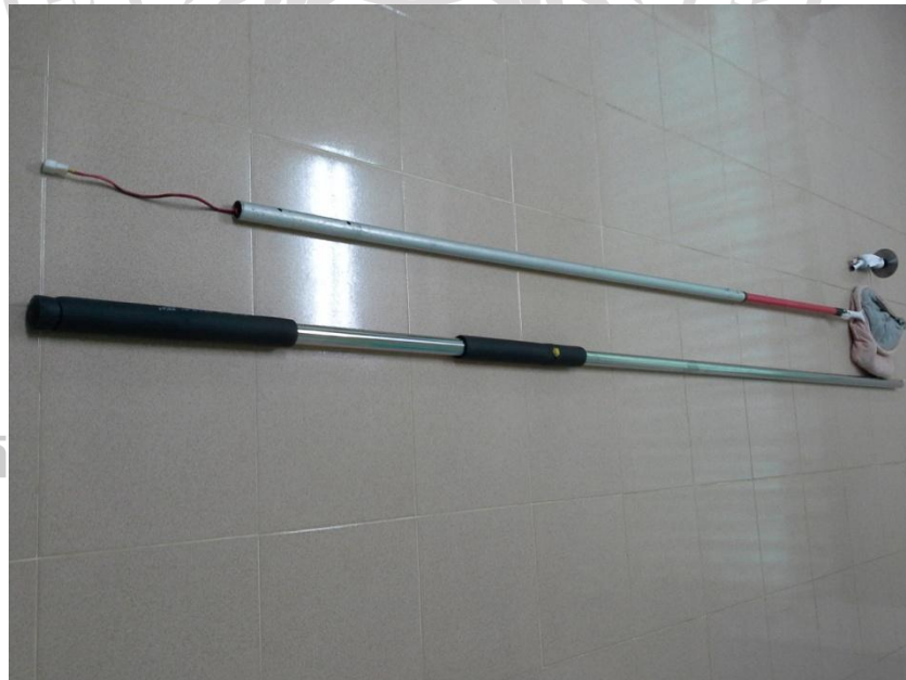
ภาพที่ 4.1 แสดงลักษณะของด้ามไม้สอยที่ทำจากท่อสแตนเลสปลอดสนิม
