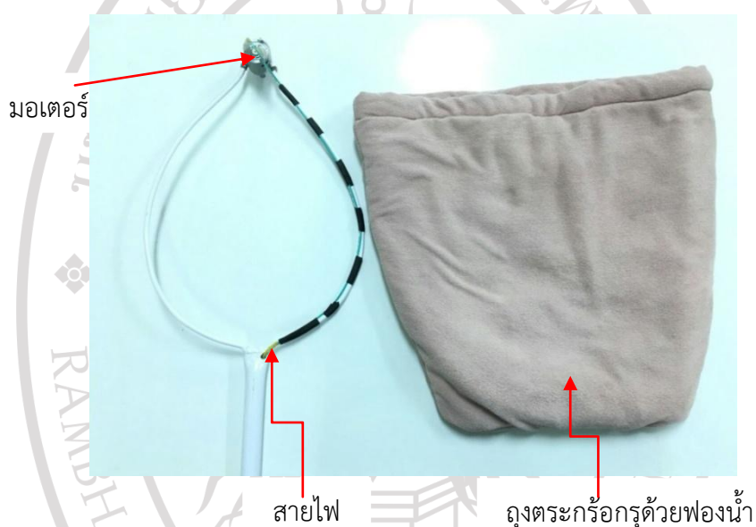
ภาพที่ 4.6 แสดงลักษณะของชุดตระกร้อรองรับผลไม้ที่ได้จัดสร้างขึ้น
