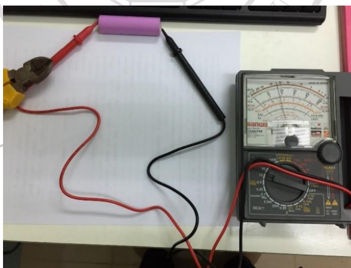
ภาพที่ 4.8 และ 4.9 ลักษณะของแบตเตอรี่ชนิดลิเทียมไอออนและการตรวจเช็คแรงดันไฟฟ้า
