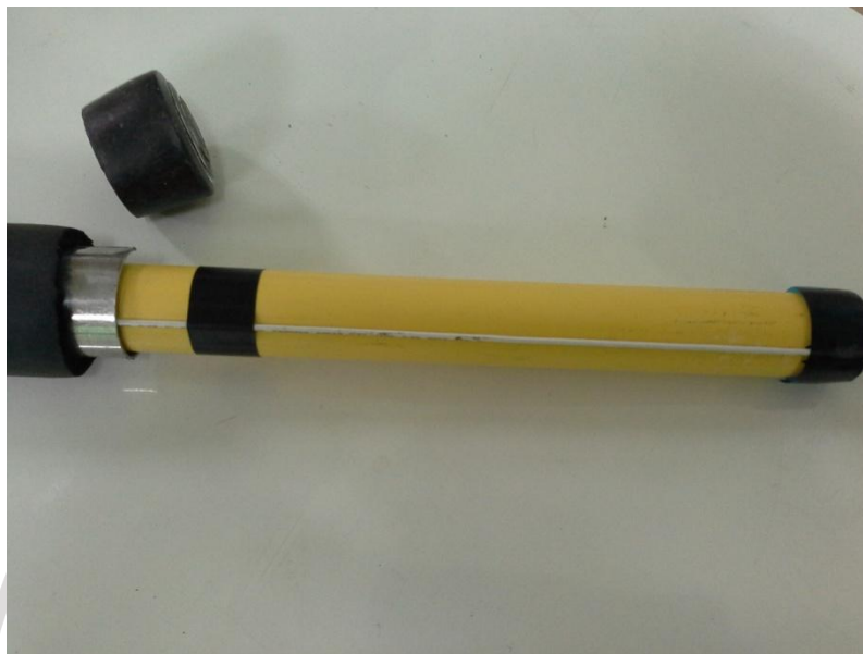
ภาพที่ 4.12 แสดงลักษณะการจัดสร้างรางถ่านแบตเตอรี่เพื่อซ่อนไว้ในด้ามสอย
