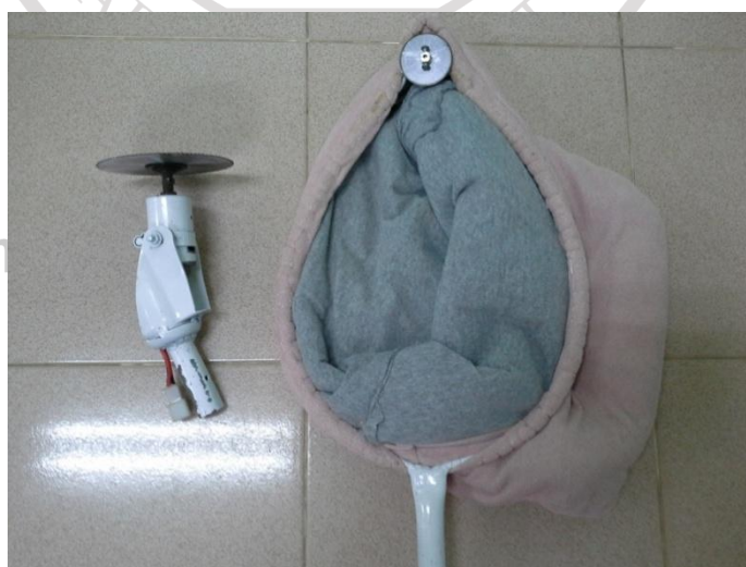
ภาพที่ 4.7 แสดงลักษณะของชุดใบมีดตัดเฉือนทั้งสองรูปแบบ
