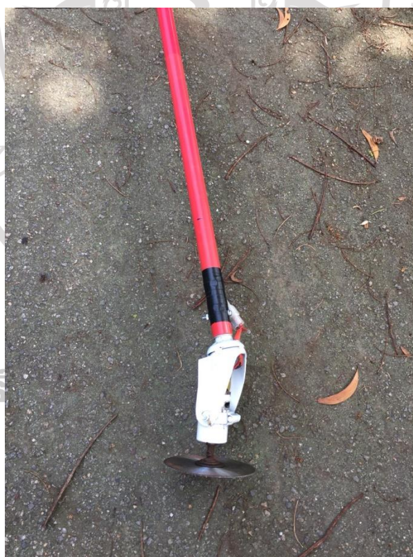
ภาพที่ ก.3 และ ก.4 แสดงการประกอบด้ามสอยทั้งสองชุดเข้าด้วยกันเพื่อใช้สำหรับเก็บเกี่ยวผลไม้ที่ไม่ต้องการป้องกันความบอบช้ำ เช่น หมากสุก
