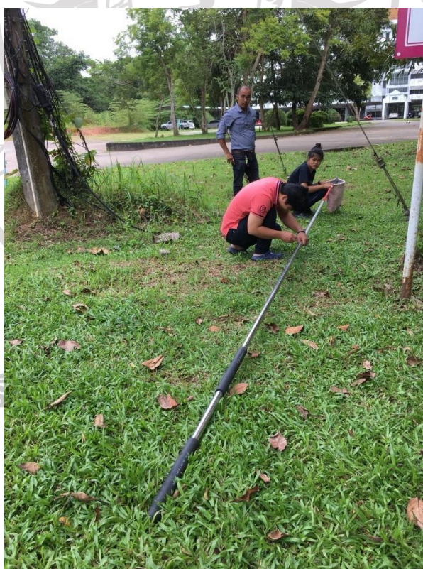
ภาพที่ ก.1 และ ก.2 แสดงการประกอบด้ามสอยทั้งสองชุดเข้าด้วยกันเพื่อใช้สำหรับเก็บเกี่ยวผลไม้ที่ต้องการป้องกันความบอบช้ำ เช่น ผลมะม่วง
