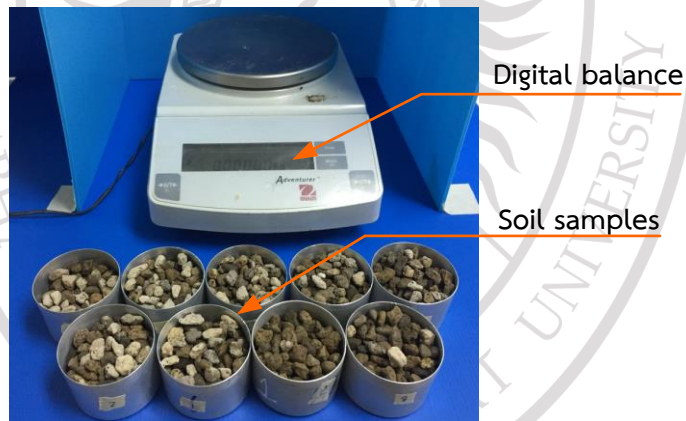
ภาพที่ 4.6 การหาค่าความชื้นด้วยวิธีการวัดแบบชั่งน้ำหนัก
