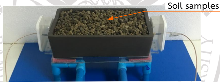
ภาพที่ 4.5 การบรรจุวัสดุปลูกในกระถางเพื่อวัดความชื้นด้วยคลื่นแม่เหล็กไฟฟ้า
