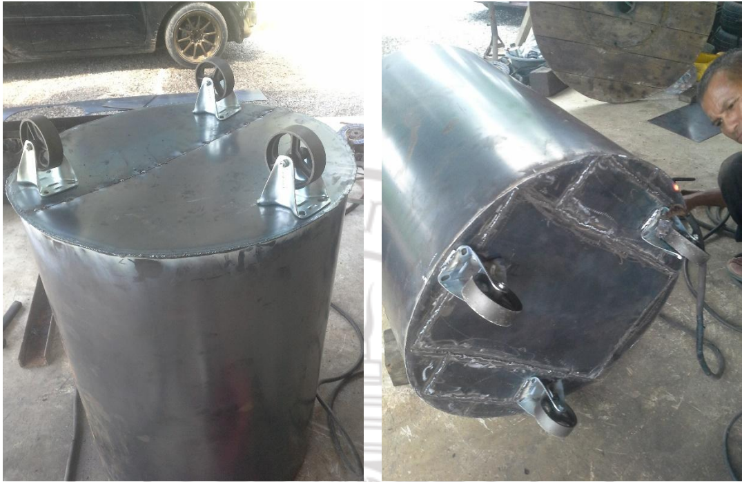
ภาพที่ 4.3 แสดงการติดตั้งล้อเหล็กจำนวน 3 ชุด สำหรับเคลื่อนย้าย
