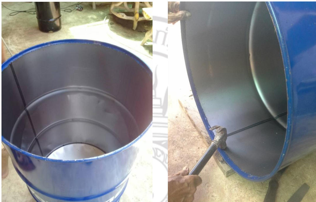
ภาพที่ 4.2 แสดงลักษณะการเปิดฝาถัง 200 ลิตร และการพับเก็บรอยคมขอบถัง
