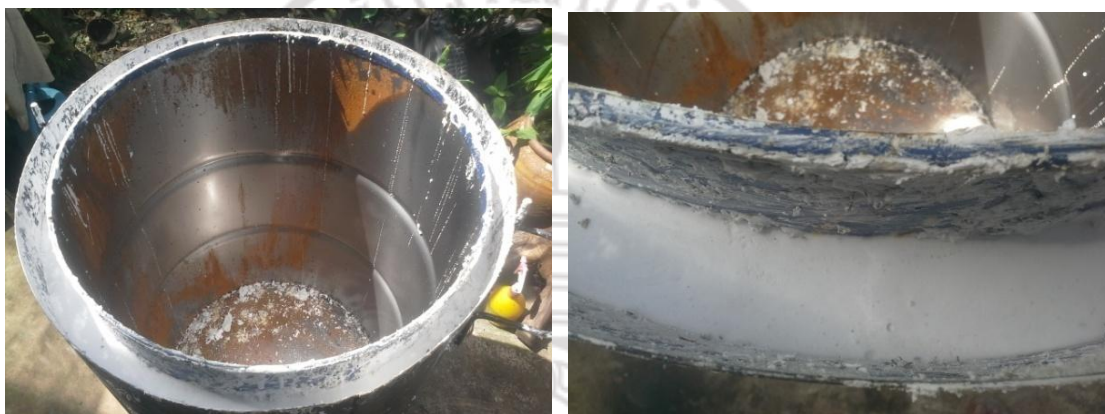
ภาพที่ 4.8 แสดงลักษณะการบรรจุฉนวนเพื่อใช้กักเก็บความร้อน
