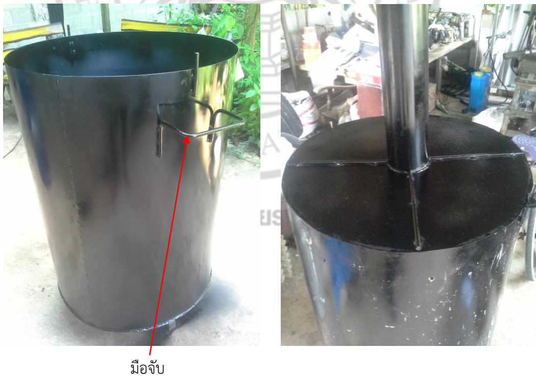
ภาพที่ 4.7 แสดงลักษณะการติดตั้งมือจับและการพ่นสีชนิดทนความร้อนสูง
