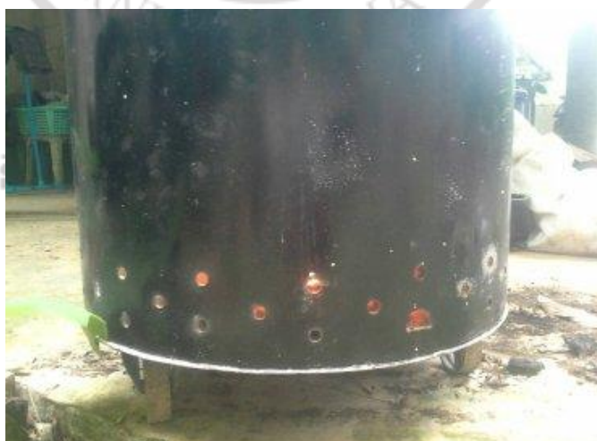
ภาพที่ 4.9 แสดงลักษณะการเจาะรูเพื่อนำอากาศเข้าบริเวณด้านล่างของเตาเผาถ่าน
