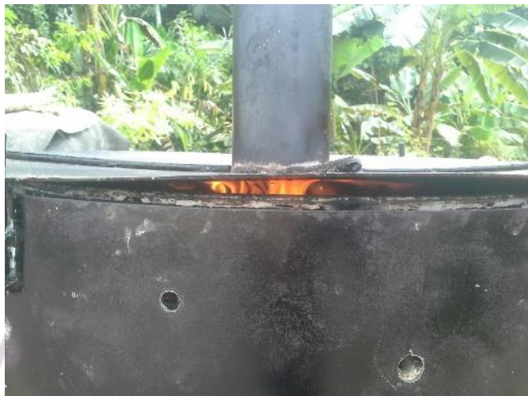
ภาพที่ 4.10 แสดงลักษณะการเจาะรูเพื่อนำอากาศเข้าบริเวณด้านบนของเตาเผาถ่าน
