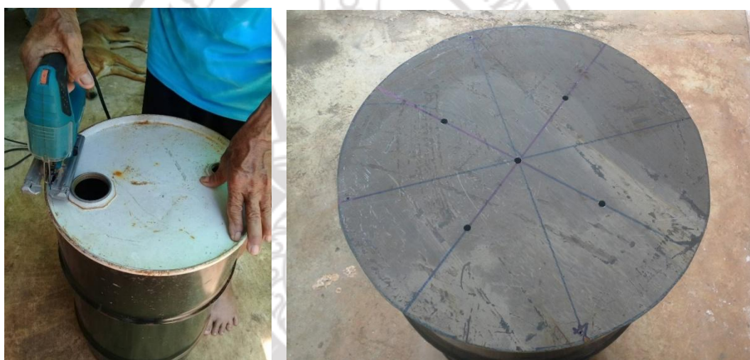
ภาพที่ 4.5 แสดงลักษณะของถังสำหรับใส่วัสดุดิบและการเจาะรูก้นถัง
