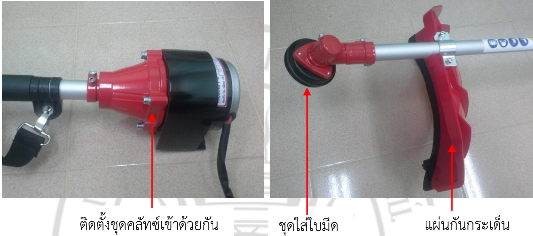
ภาพที่ 4.2 การติดตั้งชุดคลัทช์เข้ากับก้านหางและชุดใส่ใบมีดกับแผ่นกันกระเด็น
