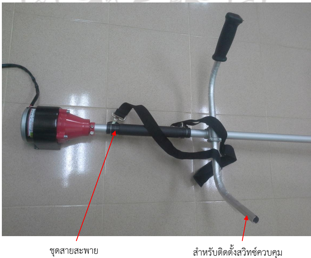
ภาพที่ 4.3 แสดงลักษณะของสายสะพายและมือจับแบบกระชับมือ
