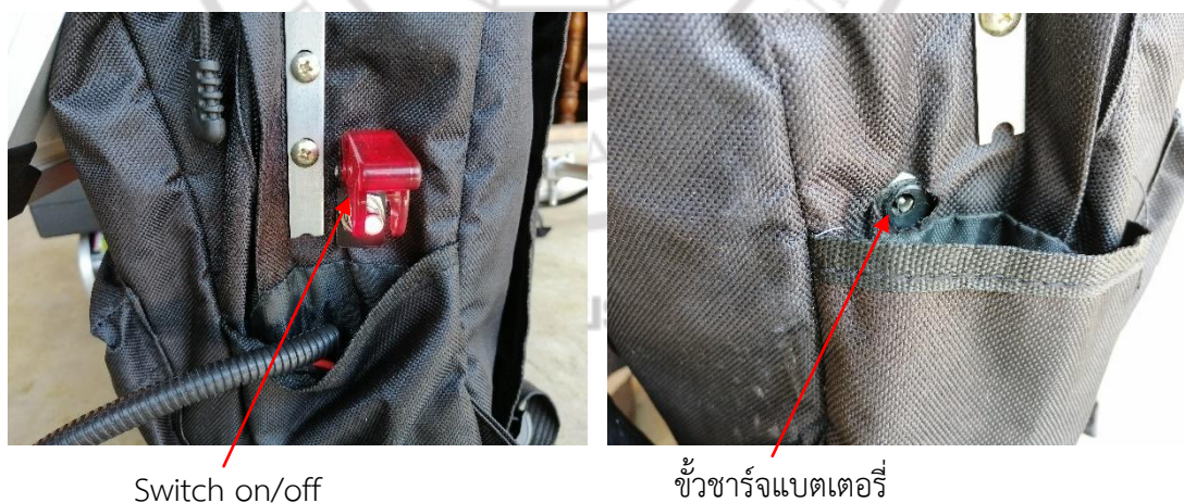
ภาพที่ 4.8 แสดงการติดตั้งสวิทช์เปิด-ปิดการทำงานและขั้วชาร์จแบตเตอรี่ ไว้บริเวณด้านข้างของกระเป๋าเป้สะพาย
