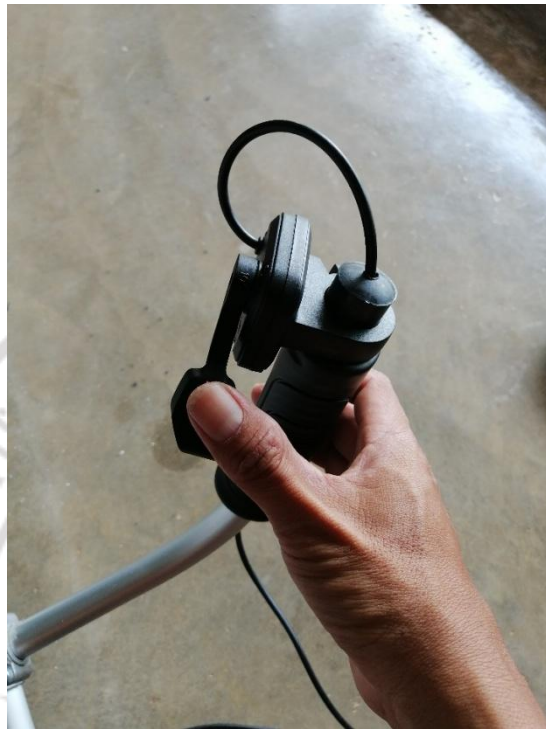
ภาพที่ 4.5 แสดงลักษณะของสวิตช์ควบคุมความเร็วเครื่องตัดหญ้า
