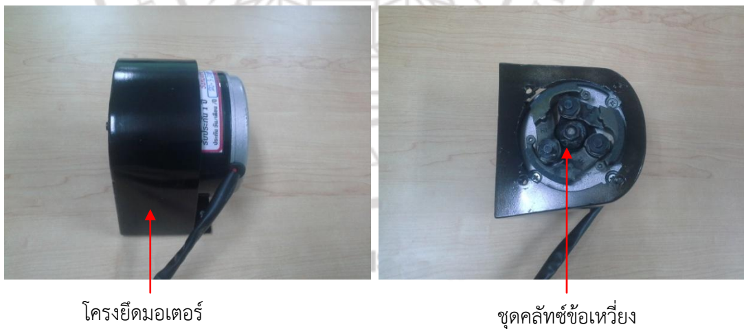
ภาพที่ 4.1 การจัดสร้างโครงสำหรับจับยึดมอเตอร์และการติดตั้งคลัทช์ข้อเหวี่ยง
