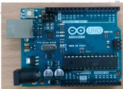
ภาพที่ 2.17 ไมโครคอนโทรลเลอร์ Arduino
