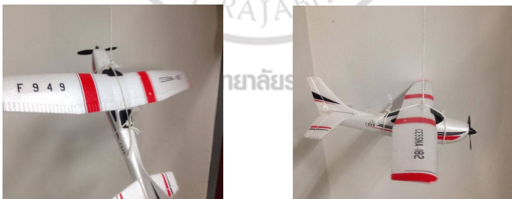
ภาพที่ 3.3 การหาจุดศูนย์กลางมวล (Center of mass) ของเครื่องบินบังคับ Cessna-182
