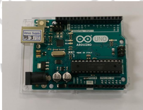
ภาพที่ 2.17 ไมโครคอนโทรลเลอร์ Arduino UNO
