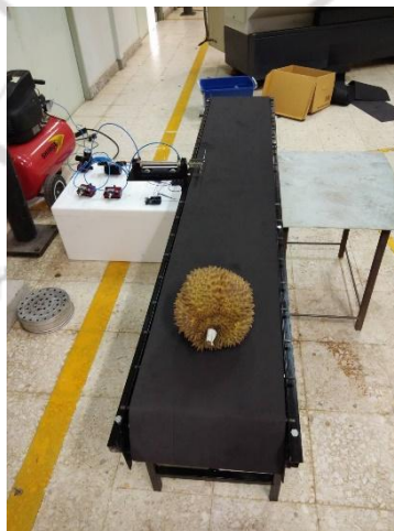
ภาพที่ 3.10 การทำงานของเครื่องคัดแยกผลไม้
