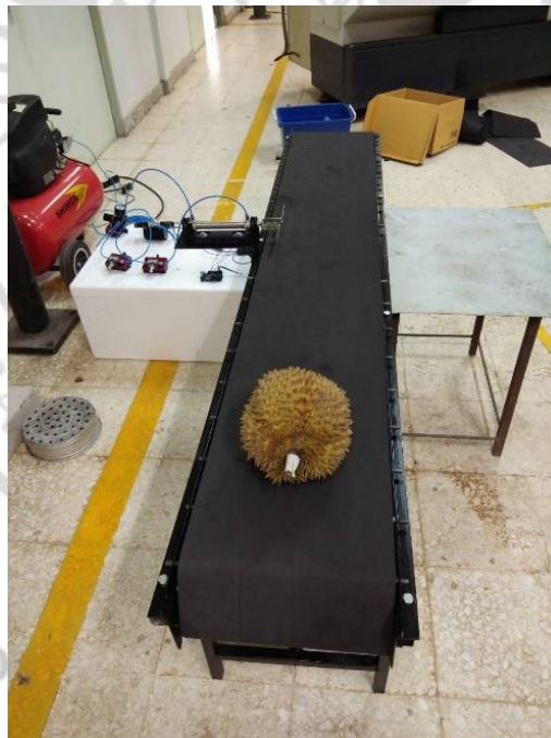
ภาพที่ 3.20 กำหนดค่าน้ำหนักที่ 1,900 – 2,000 กรัม ทดลองวางผลทุเรียนน้ำหนัก 1,966 กรัม
