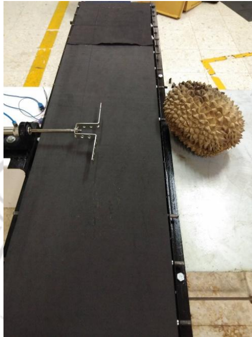
ภาพที่ 3.25 ระบบคัดแยกต้นผลทุเรียนออกจากสายพานลำเลียง
