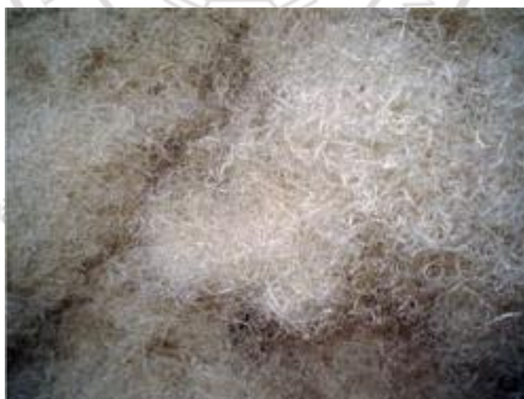
ภาพที่ 2.5 เส้นใยสับปะรดที่แยกด้วยเครื่อง Roller Card
