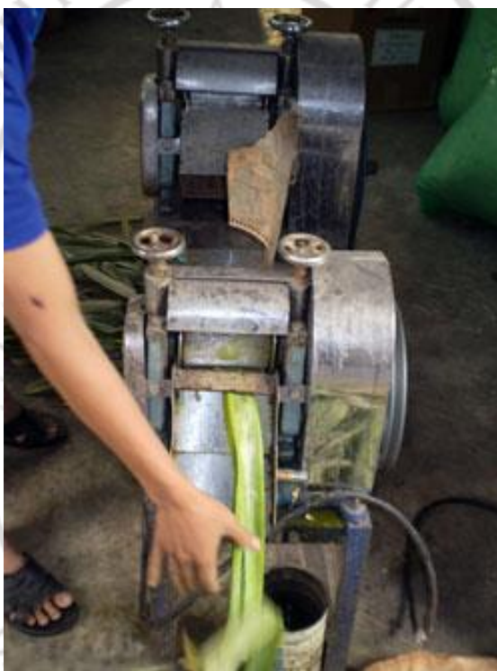
ภาพที่ 2.3 การเตรียมใบสับปะรดนำเข้าเครื่องรีดเพื่อให้ใบสับปะรดแตกหรือแยกออกจากกันมากที่สุด
