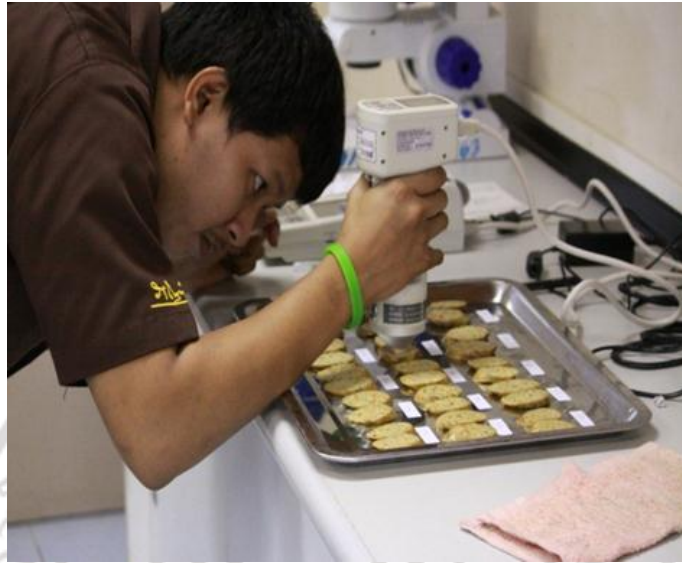
ภาพภาคผนวกที่ 7 การตรวจวัดค่าความสว่าง (lightness, L^* ) ค่าสีแดง (redness, a^* ) และค่าสีเหลือง (yellowness, b^* )
