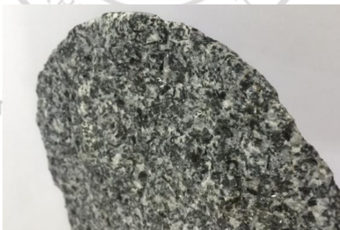
ภาพที่ 2.3 ตัวอย่างหินแกรนิตเนื้อดอกจังหวัดตาก
