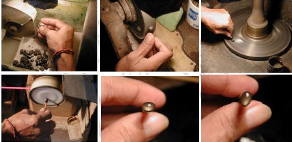
ภาพที่ 2.15 ขั้นตอนการเจียรระนาด้านพลอยแบบหลังเบี้ย (Cabochon) ที่มา : (การเจียรระนาด้านพลอย, มปป.)
