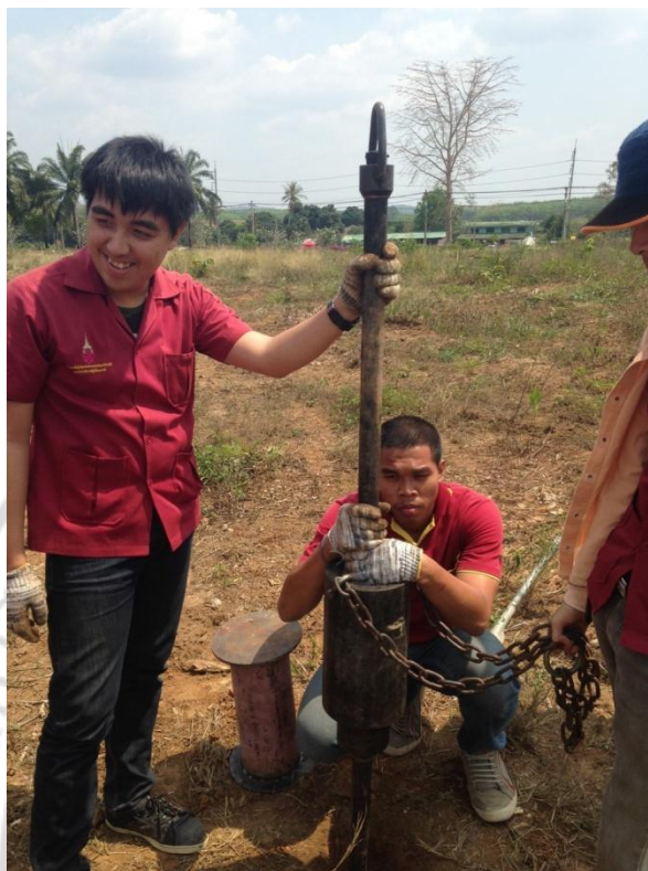
การทดสอบการตอกแบบมาตรฐาน บริเวณ วัดน้ำเขียว อ.โป่งน้ำร้อน
