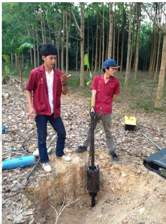
การทดสอบการตอกแบบมาตรฐาน บริเวณ บ้านอ่างครี อ.มะขาม
