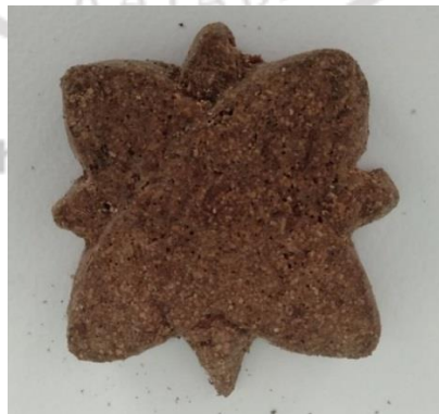
ภาพที่ 4.22 แผ่นวัสดุซีลื้อยผสมน้ำยางพาราซึ่งทำละลายจากการกดพิมพ์
