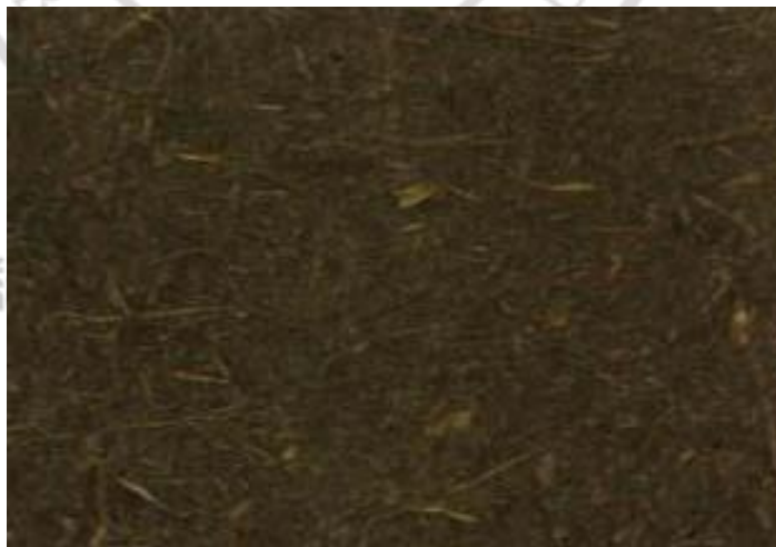
ภาพที่ 4.14 วัสดุทางเลือกรูปแบบที่ 3 ซึ่งได้จากใบยางพาราปั่นผสมน้ำยางพาราในสัดส่วน 1:1.5
