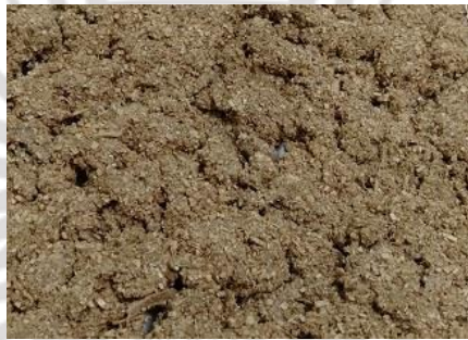
ภาพที่ 4.32 แผ่นวัสดุซีเมนต์ผสมน้ำยางพาราแบบสร้างผิวสัมผัสขรุขระ
