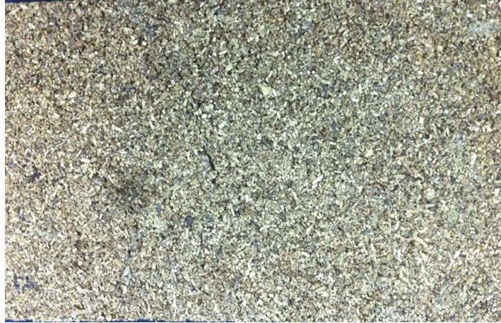
ภาพที่ 4.12 วัสดุทางเลือกรูปแบบที่ 1 ซึ่งได้จากขี้เลื่อยไม้ยางพาราผสมน้ำยางพาราในสัดส่วน 1 : 1.5
