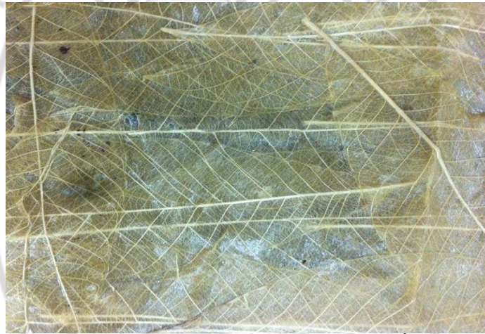
ภาพที่ 4.13 วัสดุทางเลือกรูปแบบที่ 2 ซึ่งได้จากใบยางพาราผสมน้ำยางพาราในสัดส่วน 1:1 ซึ่งเทส่วนผสมบนแผ่นกระจก
