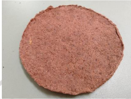
ภาพที่ 4.26 แผ่นวัสดุซีล่อยผสมน้ำยางพารารีดชนิดรีดเป็นแผ่นบาง
