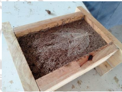
ภาพที่ 20 ขี้เลื่อยผสมน้ำยางซึ่งอัดบล็อกแล้ว
