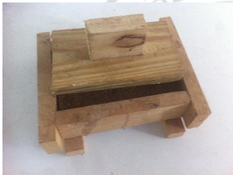
ภาพที่ 19 บล็อกไม้สำหรับอัดแผ่นวัสดุ
