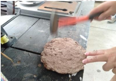
ภาพที่ 21 การเคาะขึ้นรูปแผ่นยางให้แบน
