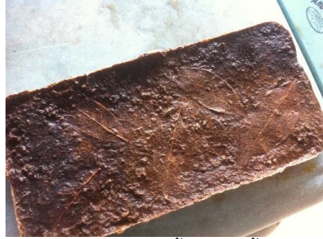
ภาพที่ 18 ทดลองผสมขี้เลื่อยกับน้ำยางแล้ว เทลงบล็อก
