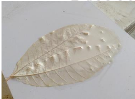
ภาพที่ 35 การทดลองเคลือบน้ำยางในโครง ใบยางบนแผ่นพลาสติกเรียบ
