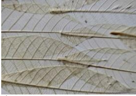
ภาพที่ 33 การทดลองเคลือบโครงใบยางด้วยน้ำ ยางพารา
