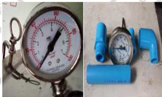
ภาพที่ 3.8 ติดตั้งเกจวัดความดันและวัดอุณหภูมิ
