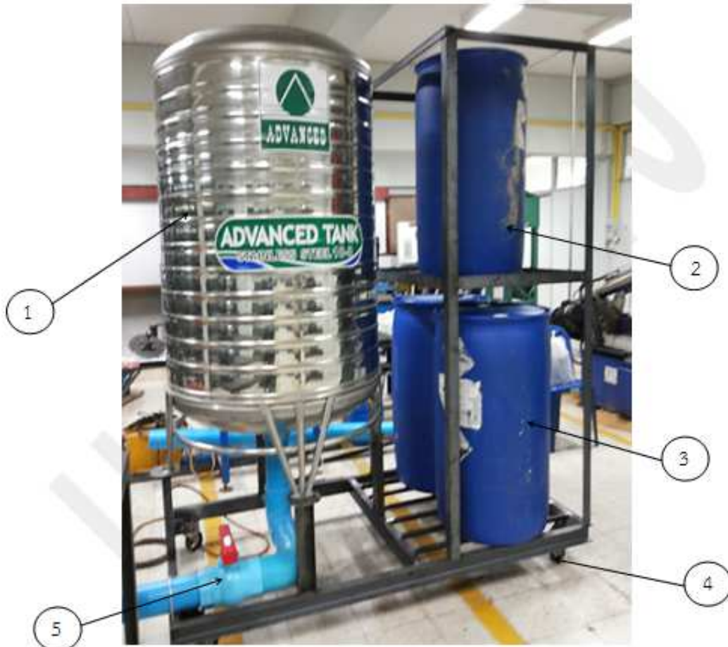
ภาพที่ 4.1 ระบบผลิตแก๊สชีวภาพจากสิ่งปฏิกูลมนุษย์
