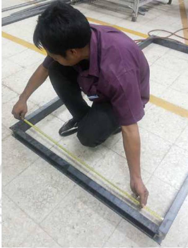
ภาพภาคผนวกที่ ก.1 การวัดโครงสร้างเพื่อเชื่อมงาน
