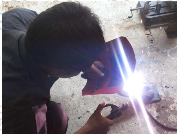
ภาพภาคผนวกที่ ก.15 การเชื่อมฐานล้อด้วยเครื่องเชื่อมไฟฟ้า
