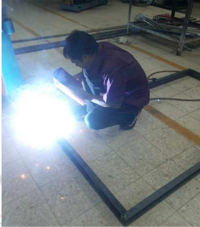
ภาพภาคผนวกที่ ก.3 การเชื่อมฐานโครงสร้าง
