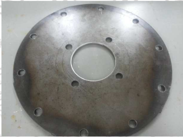
ภาพภาคผนวกที่ ก.18 ฝาครอบถังหมักแก๊สชีวภาพ
