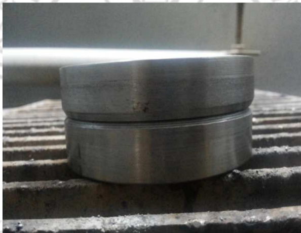
ภาพภาคผนวกที่ ก.12 การวางตำแหน่งเชื่อมชุดซีลกันรั่ว
