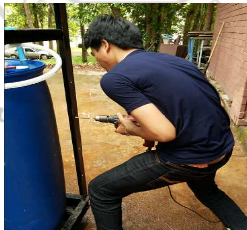
ภาพภาคผนวกที่ ก.34 ประกอบการ์ดถังแก๊สและเป็นบันไดเดินขึ้นระบบ
