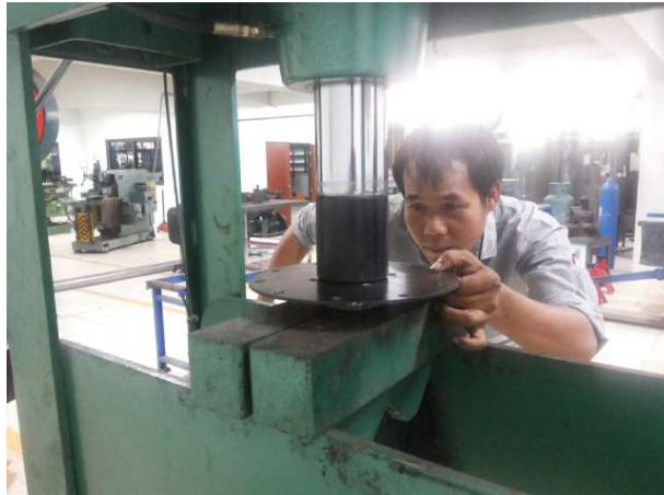
ภาพภาคผนวกที่ ก.20 การอัดชุดซีลด้วยเครื่องอัดไฮดรอลิกส์ 2
