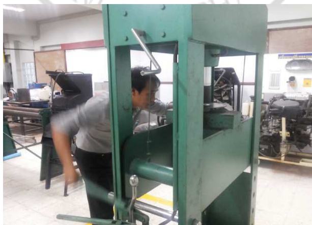
ภาพภาคผนวกที่ ก.19 การอัดชุดซีลด้วยเครื่องอัดไฮดรอลิกส์ 1
