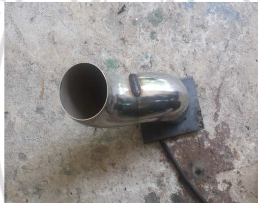
ภาพภาคผนวกที่ ก.24 การเชื่อมข้องอ 90 สแตนเลส
