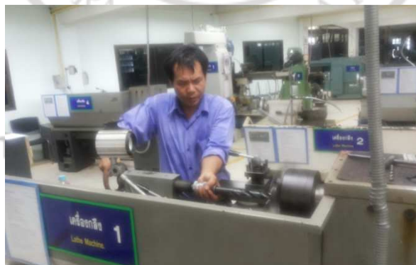
ภาพภาคผนวกที่ ก.10 การเจาะรูชิ้นงานด้วยสว่านขนาด 1 นิ้ว
