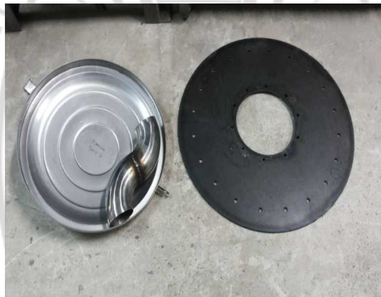
ภาพภาคผนวกที่ ก.27 ชุดฝาครอบถังหมักที่ออกแบบ
