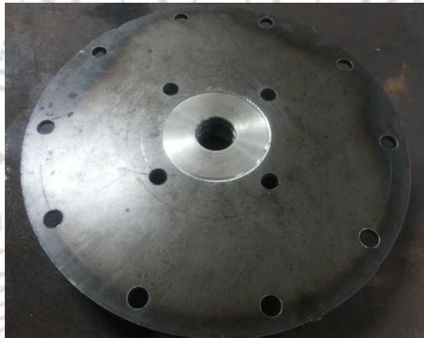
ภาพภาคผนวกที่ ก.21 ชุดซีลกันรั่วและฝาครอบที่ออกแบบ
