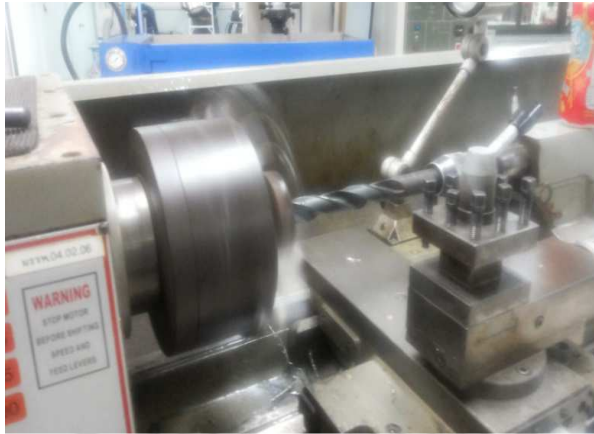
ภาพภาคผนวกที่ ก.11 การเจาะชุดซีลกันรั่วของระบบ
