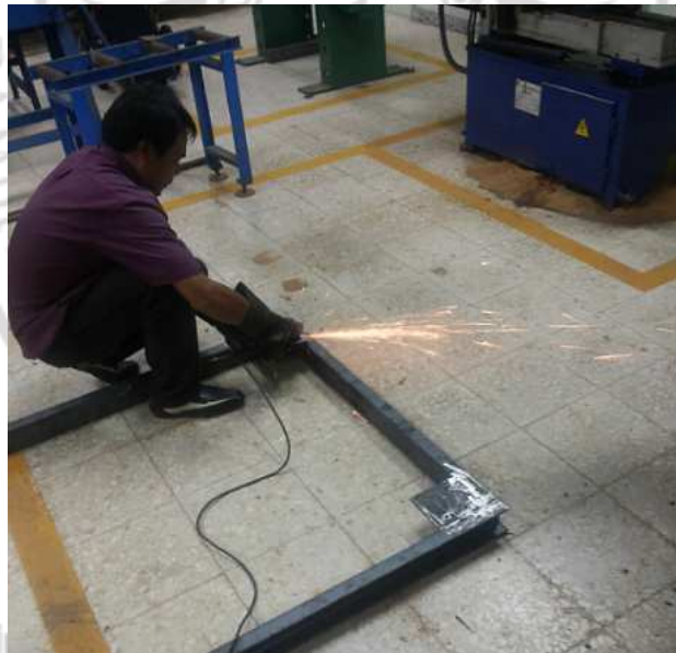
ภาพภาคผนวกที่ ก.4 ปรับแต่งฐานโครงสร้างระบบ
