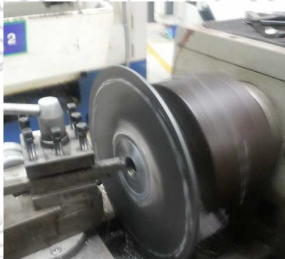
ภาพภาคผนวกที่ ก.9 การกลึงปาดหน้าชุดซีลกันรั่ว
