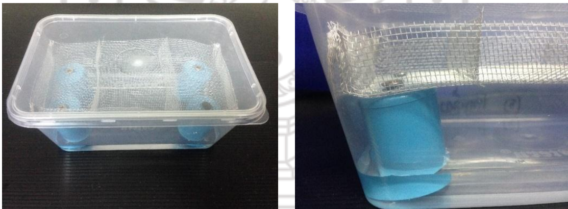
ภาพที่ 3.1 กล่องพลาสติกเร่งอายุตัดแปลง ปริมาตร 1 ลิตร ประกอบด้วย ตะแกรงลวดสำหรับบรรจุเมล็ดพันธุ์ข้าวจำนวน 3 ช่อง โดยวางให้เห็นีระดับน้ำ
