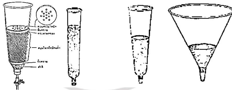
ภาพที่ 2.5 ลักษณะอุปกรณ์ที่ใช้ในการสกัดสารด้วยวิธี percolator
