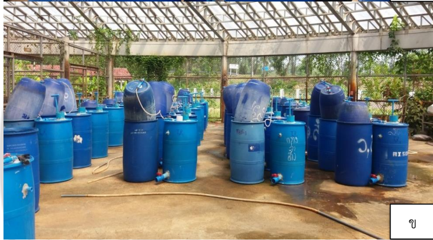
ภาพภาคผนวกที่ 5 เริ่มทำการทดลอง ก) เติมน้ำใส่ถังหมัก ข) ระบบการหมักที่สมบูรณ์
