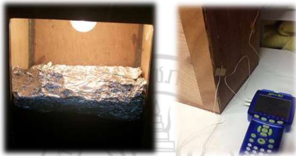
ภาพที่ ก.4 วิธีการทดลองฉนวนโดยใช้หลอดไฟ 100 วัตต์ เป็นแหล่งกำเนิดความร้อน
