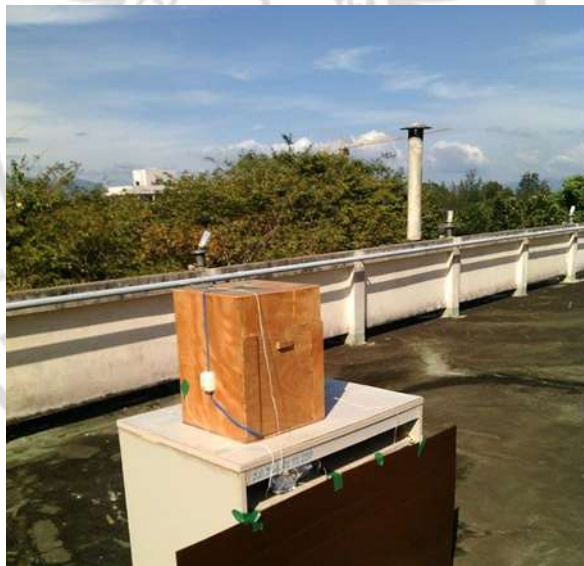
ภาพที่ ก.5 การทดลองฉนวนโดยใช้ดวงอาทิตย์เป็นแหล่งกำเนิดความร้อน
