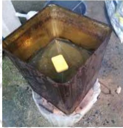
ภาพที่ ก.1 ต้มใยยางพาราสดกับสบู่อัลไลต์ เพื่อให้ได้เส้นใยยางพารา
