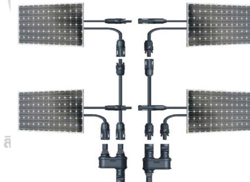
ภาพที่ 2.9 การเชื่อมต่อแผงโซลาร์เซลล์ ที่มา : (นครินทร์ รินผล, 2559 : 13)
