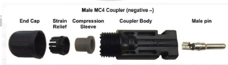
ภาพที่ 2.6 ส่วนประกอบของ MC4 ตัวผู้ (ขั้ว -) ที่มา : (นครินทร์ รินผล, 2559 : 12)
