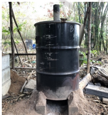
ภาพที่ 4.2 (ก) เตาเผาขนาด 200 ลิตร (ข) การจัดเรียงไม้ในเตา
