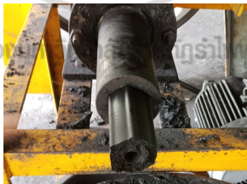
ภาพที่ 4.9 การขึ้นรูปเมื่ออัดแท่ง ออกมาเป็นเส้นยาว
