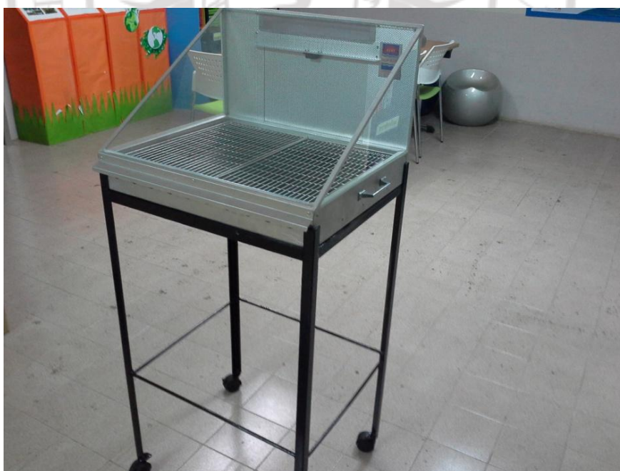
ภาพที่ 4.8 แสดงลักษณะการจัดวางเตาอบพลังงานแสงอาทิตย์เข้ากับชุดขาตั้งแบบมีล้อเลื่อน
