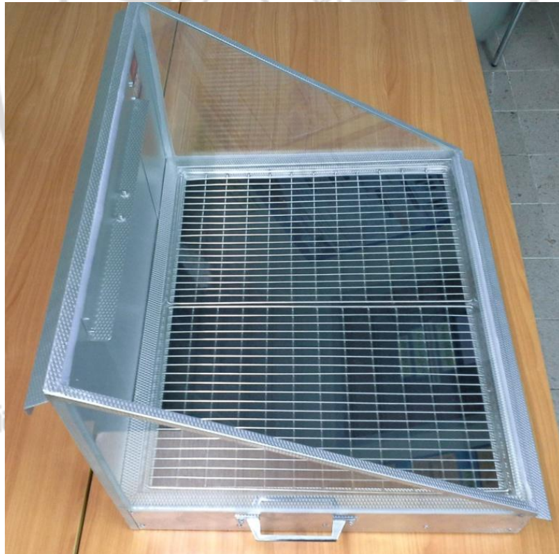
ภาพที่ 4.1 แสดงลักษณะของเตาอบพลังงานแสงอาทิตย์ชนิดปลอดภัย
