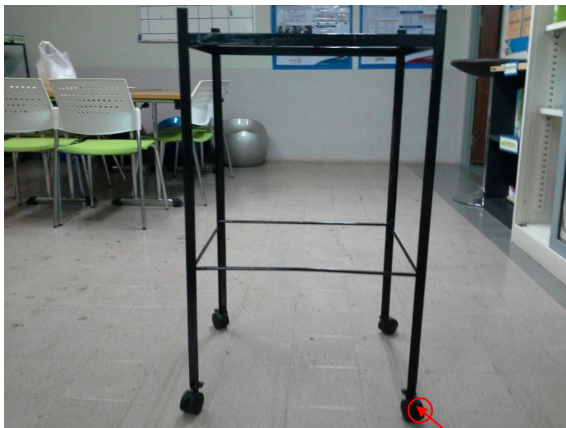
ติดตั้งล้อเลื่อน
