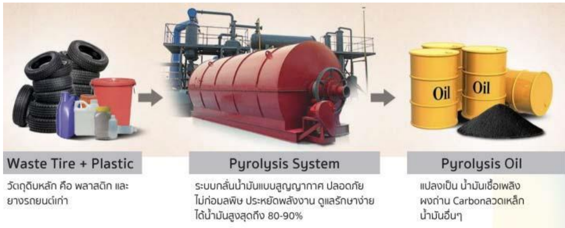
ภาพที่ 2.21 การแปรรูปขยะพลาสติกเป็นน้ำมันเชื้อเพลิง (PYROLYSIS Conceptual)
