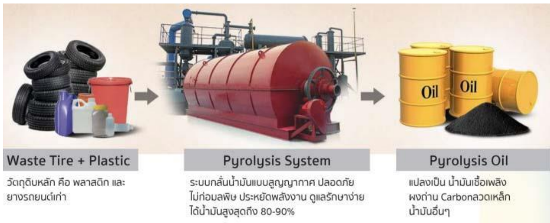
ภาพที่ 2.17 การแปรรูปขยะพลาสติกเป็นน้ำมันเชื้อเพลิง PYROLYSIS Conceptual
