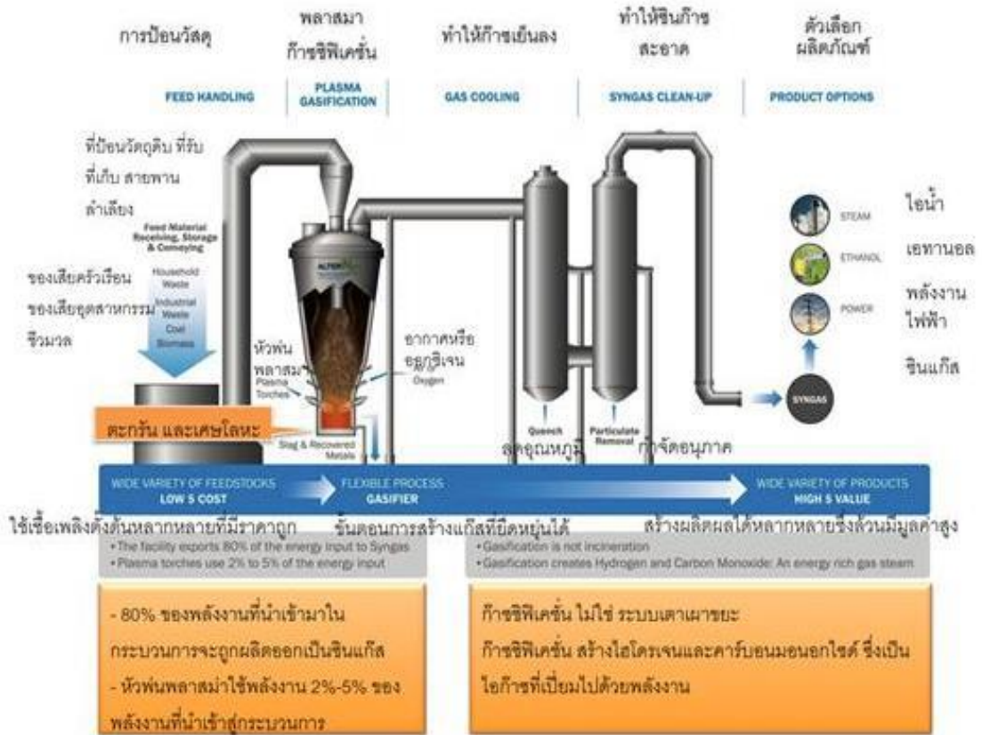
ภาพที่ 2.13 การผลิตก๊าซเชื้อเพลิงจากขยะ
