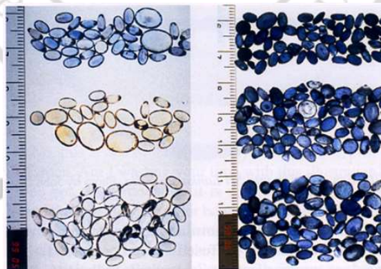
ภาพที่ 2.7 แสดงพลอยไพลินจากแหล่งศรีลังกา ก่อนและหลังเผาเคลือบสี
