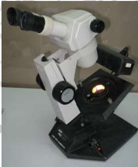
ภาพที่ 2.12 กล้องจุลทรรศน์วิเคราะห์อัญมณี
