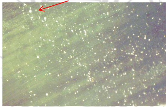
ภาพที่ 4.35 แสดงมลทินผลึกแร่ (mineral inclusion) ของตัวอย่างที่ 350/18_02
