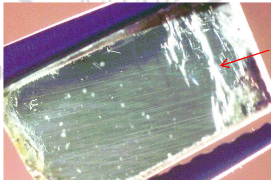
ภาพที่ 4.30 แสดงมลทินรอยแตก (fracture inclusion) ของตัวอย่างที่ 350/6_03
