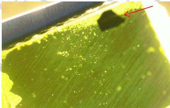
ภาพที่ 4.22 แสดงมลทินผลึกแร่สีดำ (black mineral inclusion) ของตัวอย่างที่ 450/12_01
