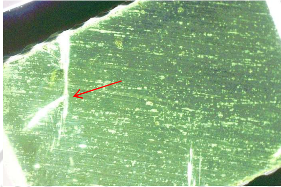
ภาพที่ 4.28 แสดงมลทินรอยแตก (fracture inclusion) ของตัวอย่างที่ 350/6_01
