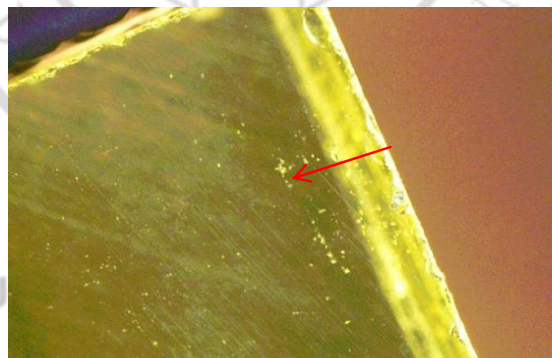
ภาพที่ 4.4 แสดงมลทินผลึกแร่ (crystal inclusion) ของตัวอย่างที่ 350/12_01
