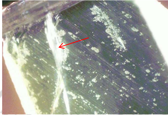
ภาพที่ 4.14 แสดงมลทินรอยแตก (fracture inclusion) ของตัวอย่างที่ 400/12_02
