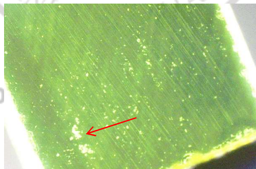
ภาพที่ 4.33 แสดงมลทินผลึกแร่ (mineral inclusion) ของตัวอย่างที่ 350/12_03
