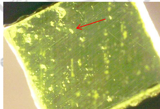
ภาพที่ 4.39 มลทินผลึกแร่ (crystal inclusion) ของตัวอย่างที่ 400/6_03
