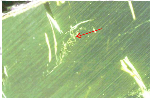
ภาพที่ 4.51 มลทินรอยแตกเชื่อมประสาน (heal fracture inclusion) ของตัวอย่างที่ 450/12_03
