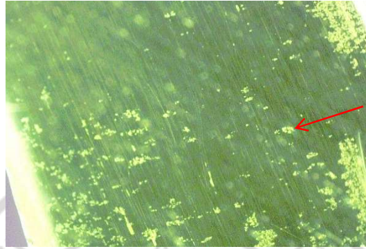
ภาพที่ 4.34 แสดงมลทินผลึกแร่ (mineral inclusion) ของตัวอย่างที่ 350/18_01
