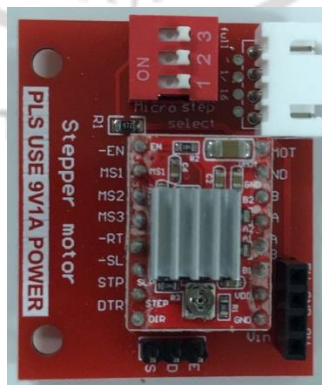
ภาพที่ 4.9 วงจรขับมอเตอร์ (ก) ด้านหน้า (ข) ด้านหลัง
