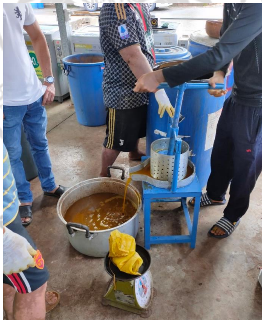
ภาพที่ 4.4 แสดงการคั้นกากสมุนไพรโดยใช้เครื่องคั้นกะทิในกระบวนการผลิตยาทาสำหรับรักษาโรคสะเก็ดเงิน
